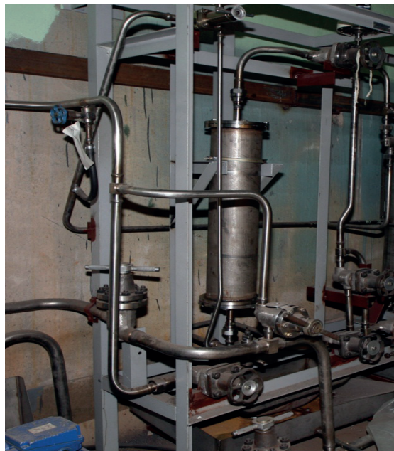
Рис. 3. Внешний вид опытных образцов высокоградиентных магнитных фильтров независимо от их типа
