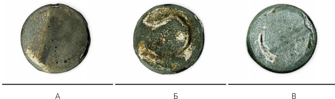
Рисунок 5 – Вид покрытия у образца № 5: сталь с нанесенной композицией ЦИНЭП
