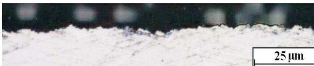
Рисунок 1 – Оксидная пленка на поверхности образца стали 10Х после ацетатной пассивации при увеличении 2000 крат
