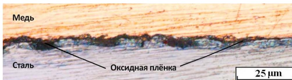
Рисунок 2 – Оксидная пленка на поверхности образца стали 12Х после ацетатной пассивации при увеличении 2000 крат
