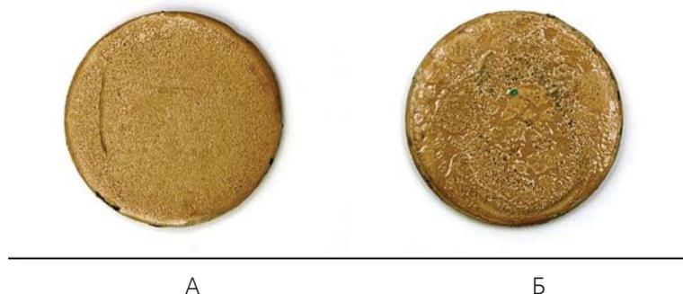
Рисунок 6 – Вид покрытия у образца № 6: сталь с композицией ЦИНЭП и покрытием эмалью ВИНИКОР ЭП-1155Д – 300 мкм
