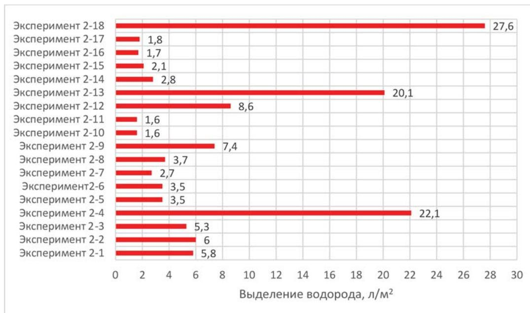
Рисунок 4 – Диаграмма изменения количества выделившегося водорода при нагреве образцов до температуры 150 °С (и кратковременном нагреве до 215 °С) с нанесенной композицией ЦИНЭП и покрытиями ВИНИКОР ЭП-1155Д – 300 мкм и ВИНИКОР ЭП-5285 – 300 мкм
