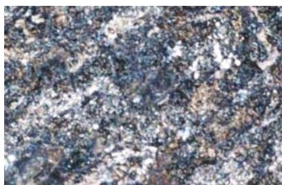
Рисунок 6 – Состояние поверхности образца стали 12Х после «трилонной» пассивации при увеличении 2000 крат
