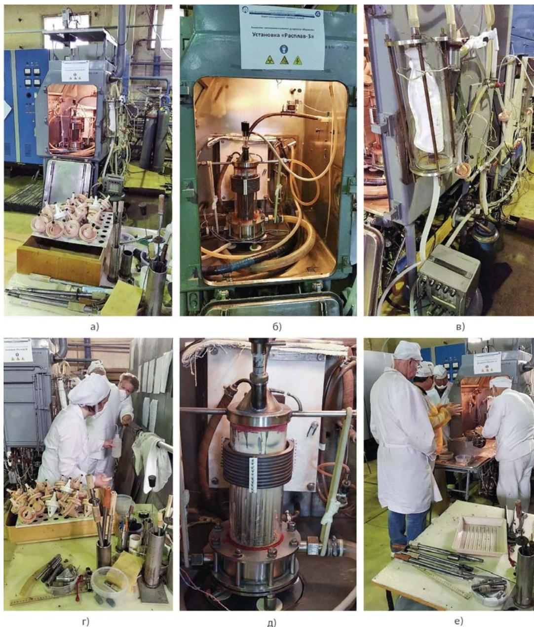
Рисунок 1 – Внешний вид экспериментальной установки «Расплав-3», подготовленной к проведению исследований выхода паров и аэрозолей из расплава теплоносителя и расплава системы «свинец-сталь» в окислительной атмосфере:
