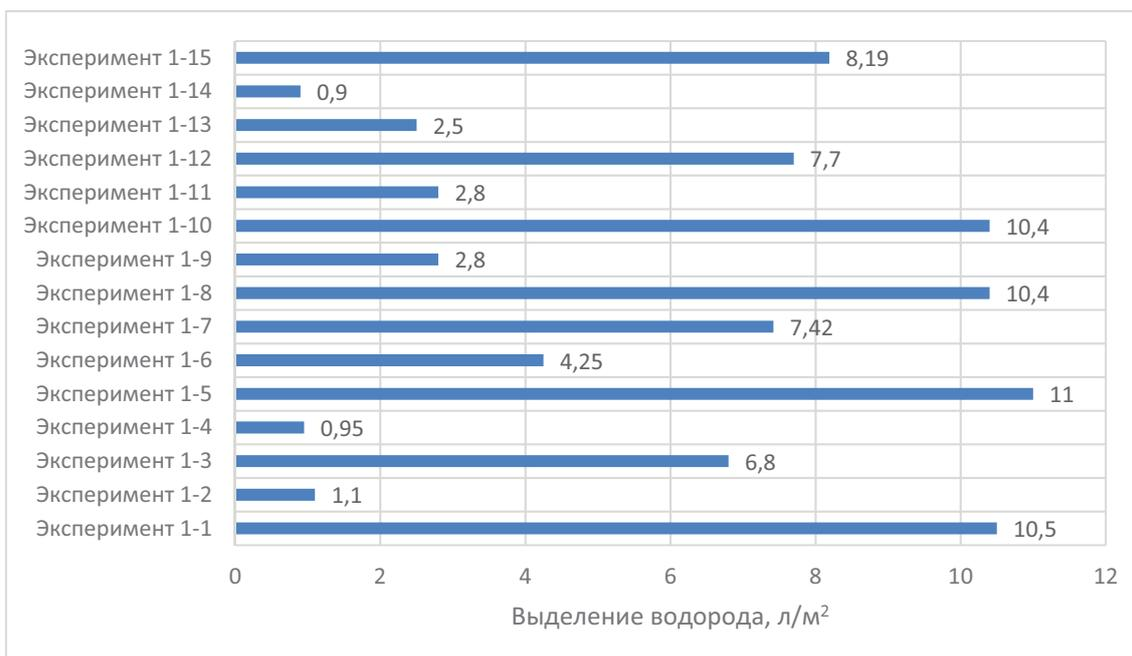
Рисунок 2 – Диаграмма изменения количества выделившегося водорода при нагреве образцов до температуры 150 °С (и кратковременном нагреве до 215 °С) с металлизацией алюминием и покрытиями ВИНИКОР ЭП-1155Д – 250 мкм и ВИНИКОР ЭП-5285 – 250 мкм
