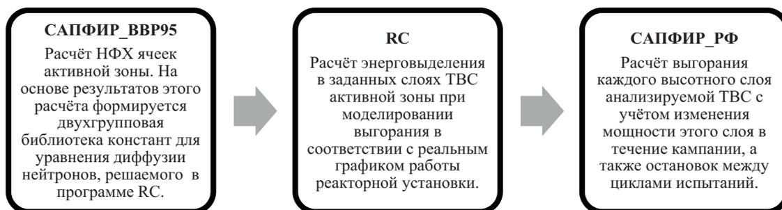
Рисунок 1 – Схема расчёта накопления реперных изотопов
