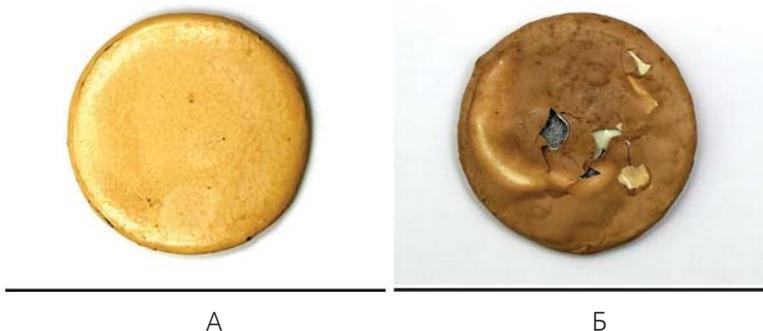
Рисунок 7 – Вид покрытия у образца № 7: сталь с композицией ЦИНЭП и покрытием эмалью ВИНИКОР ЭП-5285 – 300 мкм:
