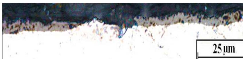
Рисунок 8 – Оксидная пленка на поверхности образца ТОТ испарительного модуля после «трилонной» пассивации при увеличении 2000 крат
