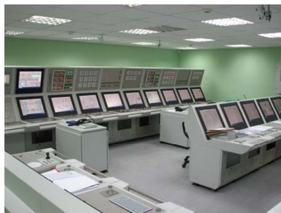
Полномасштабный тренажер для первой плавучей атомной ТЭС
